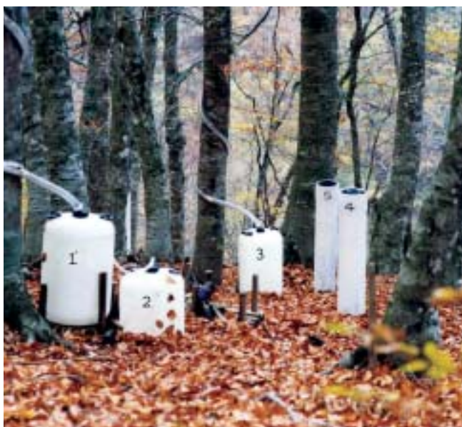
Συσκευές μέτρησης κορμοαπορροής (1,2,3) και διαπερώσας βροχής (4,5) σε δάσος οξιάς της ΒΑ Όσσας (Κισσάβου).
